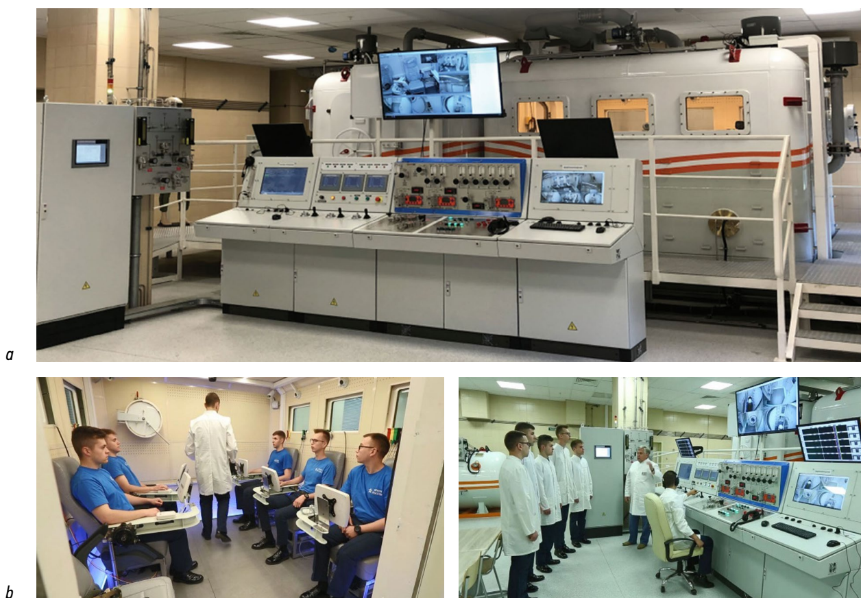
Рис. 1. Барокамеры БКПД-5-1: а — единый пульт управления; б — внутреннее оборудование. © Военно-медицинская академия им. С.М. Кирова, 2025. Публикуется с разрешения правообладателя. Источник: архив кафедры авиационной и космической медицины Военно-медицинской академии им. С.М. Кирова.
