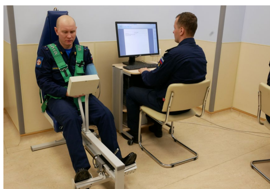
Рис. 6. Программно-аппаратный комплекс «Статоэргометр-ЭУ». © Военно-медицинская академия им. С.М. Кирова, 2025. Публикуется с разрешения правообладателя. Источник: архив кафедры авиационной и космической медицины Военно-медицинской академии им. С.М. Кирова.
